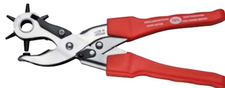
**N65080** - Fustellatrice a revolver, in acciaio speciale ad alta resistenza, esecuzione nichelata, revolver con blocco per la fustella da utilizzare, per forare pelle, cartone, gomma, stoffa ed altri materiali simili, molla di riapertura con fermo di chiusura, impugnature rivestite in PVC.
